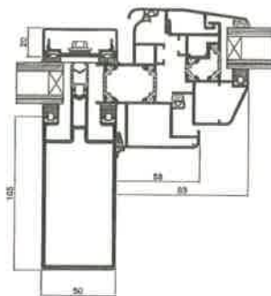
przekrój przez okno połaciowe w fasadzie
