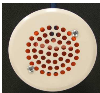
Rys. 12.5. Punkt pomiaru ciśnienia statycznego (wersja do zamurowania w ścianie).
