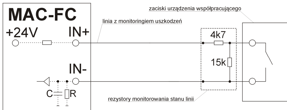
Rys.13.10 Schemat podłączenia linii z monitoringiem uszkodzeń do regulatora MAC-FC(R).
