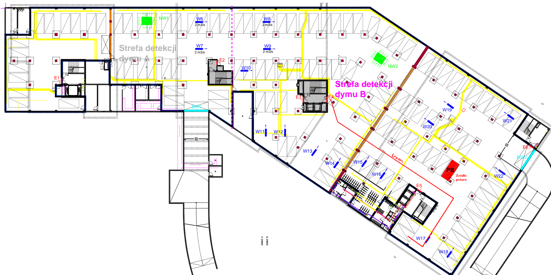
Rysunek 5. Praca instalacji w trybie wentylacji oddymiającej. Pożar „PB” w strefie detekcji dymu „B”.
