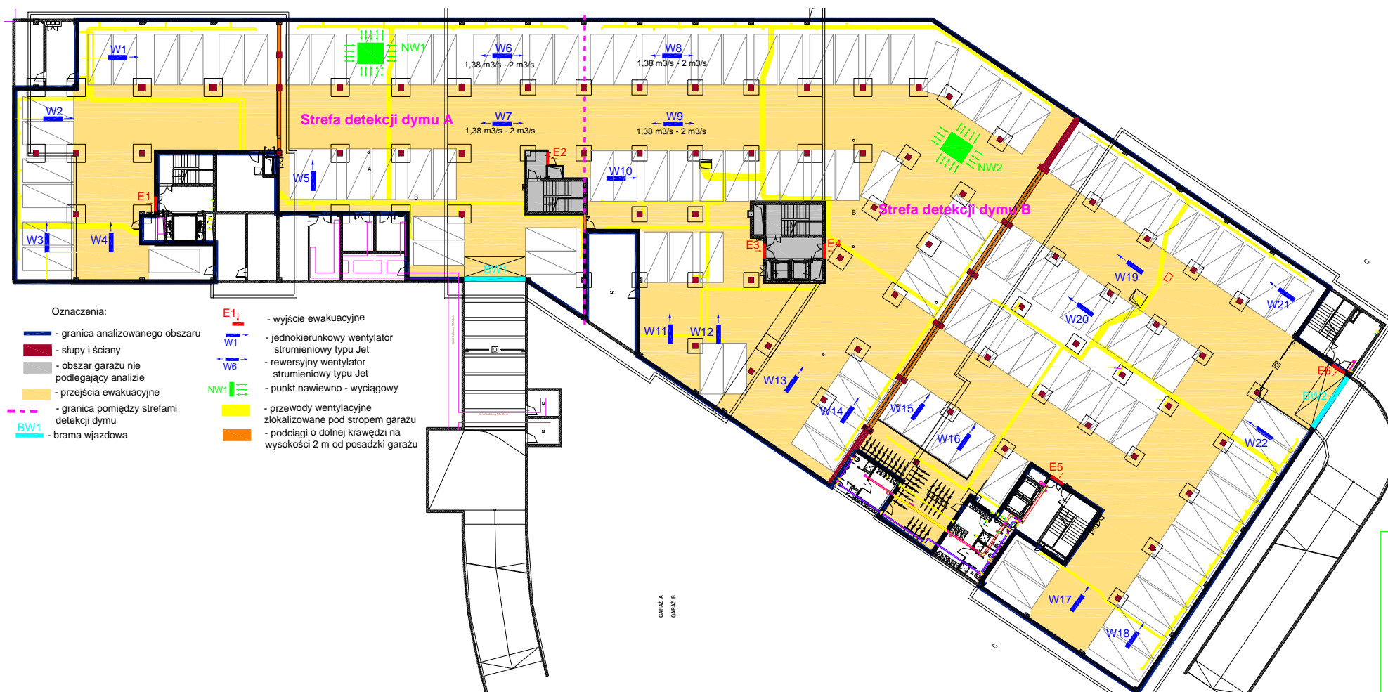
Rysunek 1. Schemat garażu i instalacji wentylacji pożarowej – kondygnacja „-1”.
